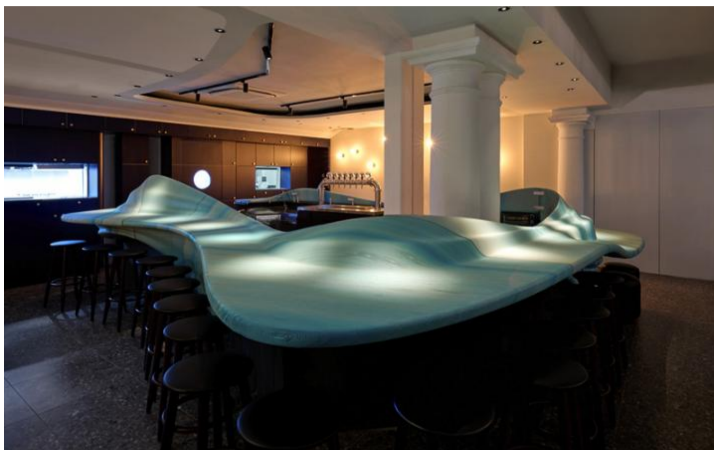
采用巨型3D 打印机，以可循环塑料瓶为材料制造的吧台。（图 / Analogue 提供）
